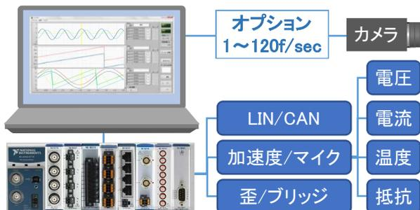
入力信号に合わせ、モジュールを選択しシャーシに差込めば自動認識し計測を開始できます。表示は物理演算されデータ保存は演算を行う前の電圧値として保存され再演算が可能で、オフラインで再表示、データエクスポートができます。
